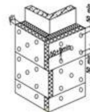
Схема крепления утеплителя на углу здания (Scheme of insulation fastening at the corner of the building)
